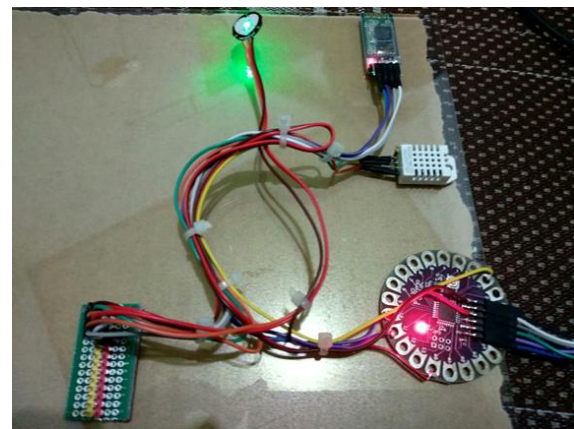
Gambar 6. Implementasi Arduino Lilypad
